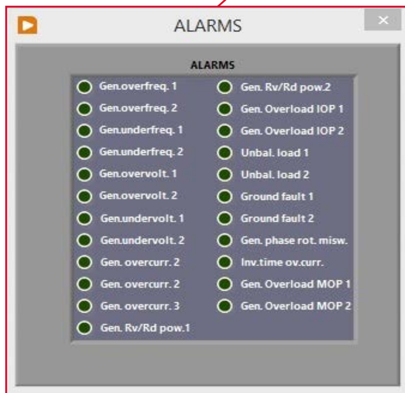
Panneau d'alarme pour le générateur.
