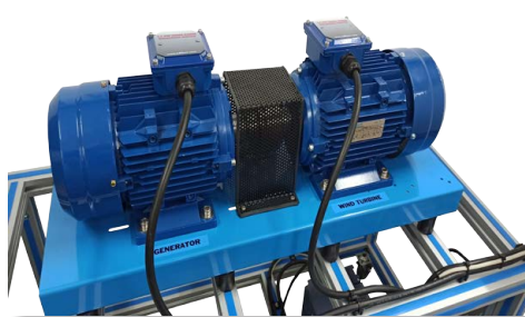
Détail du Groupe Moteur-Générateur
